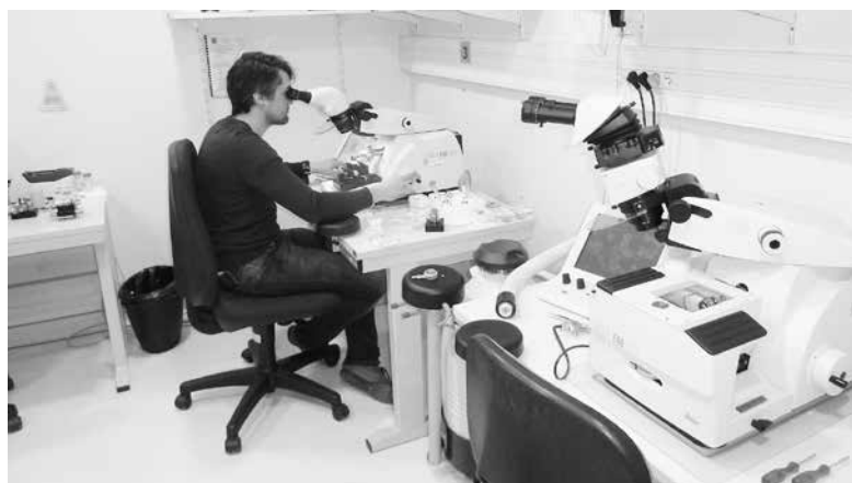
Réalisation de coupes ultrafines (70 nm d'épaisseur) pour la microscopie électronique à l'ultramicrotome
